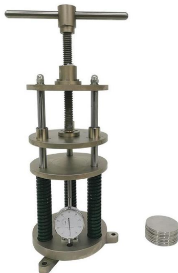
Figura 3 Testador de Recuperação de Compressão GT-KB21, nesse equipamento o material é colocado internamente entre os dois discos onde é medido a recuperação à compressão do material.
