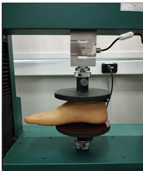
Figura 4 Equipamentos para o teste conceito na máquina de compressão, na figura é visível a célula de carga medindo a compressão no pé, no laboratório de matérias do INSPER
