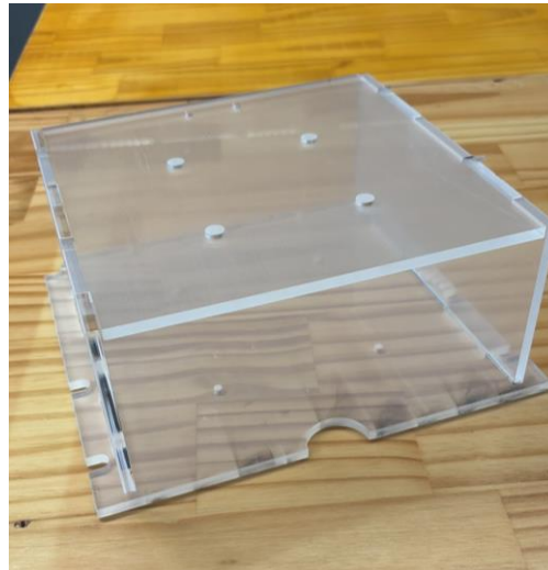
Figura 37 - Caixa para fixação dos sensores e da Optiplex
