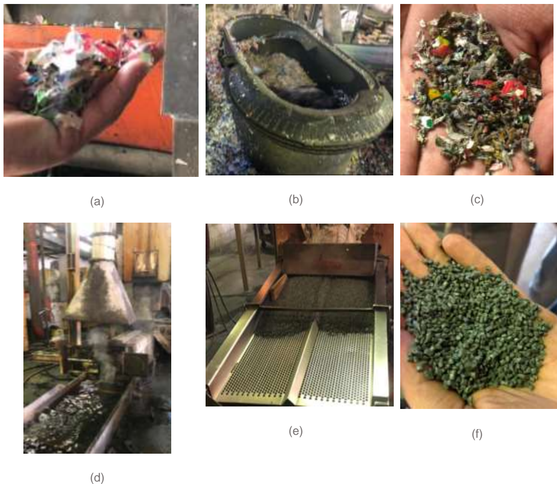
Figura 10. Processo de reciclagem na empresa J.J Plast. (a) Material pós-aglutinador. (b) Aglutinador. (c) Material pós-aglutinador. (d) Material sendo extrudado. (e) Filtragem dos Pellets. (f) Pellets ao final da reciclagem. Fonte: Autoria própria.
